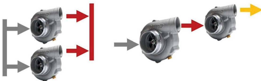
図 5-11: 必要とされる能力と圧力比を満たすために、並列と直列を結合させた組み合わせによるコンプレッサの構成
