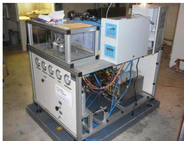
図 4-5: エジェクタ冷凍システムの実験的なセットアップ; (a) 概略図; (b) 研究所プロトタイプの概観 [Minea, 2011a; Minea, 2013]
